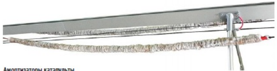
Амортизаторы катапульти из многослойной резины.
