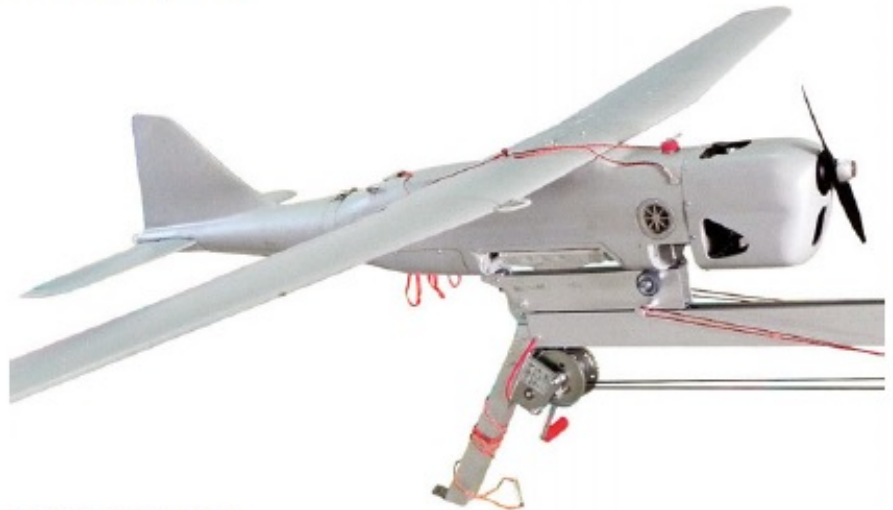
Беспилотник «Орлан-10», установленный на каретке катапульти.
