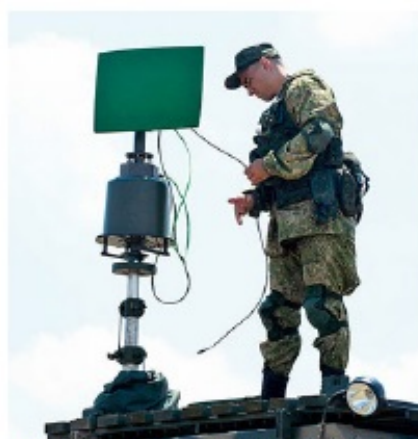
Установка и подключение антенны каналов связи НПУ с аппаратурой наблюдения и управления беспилотников (ДИМК МО РФ).
