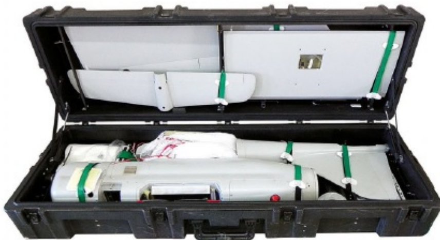
Транспортный контейнер для перевозки и хранения БЛА «Орлан-10».
