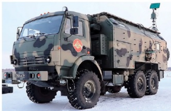
Подвижный наземный пункт управления БАК ВН «Орлан-10» на шасси многоцелевого автомобиля повышенной проходимости КамАЗ-5350 (ДИМК МО РФ).
