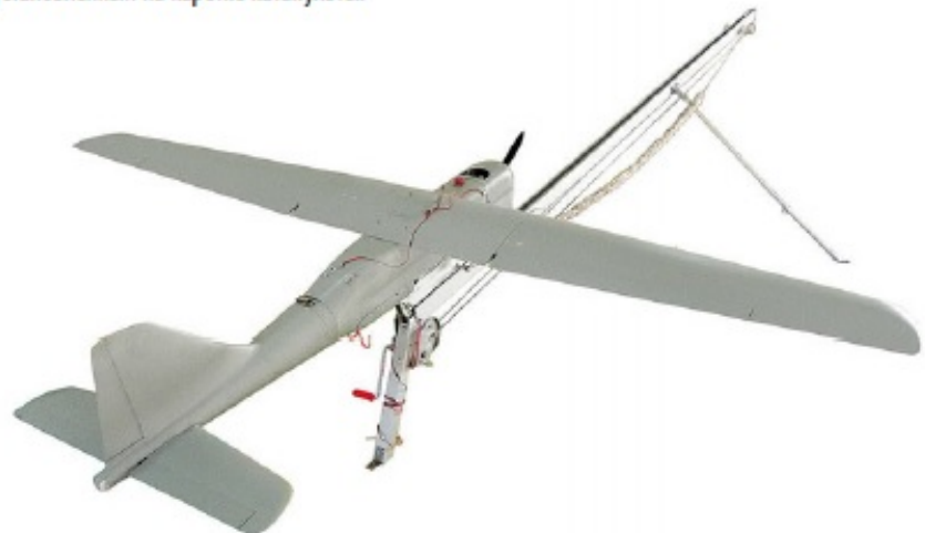
Беспилотник «Орлан-10», установленный на каретке катапульти.
