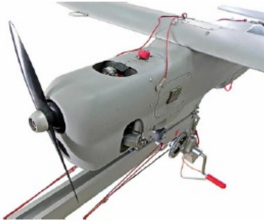
Силовая установка БЛА «Орлан-10»:
