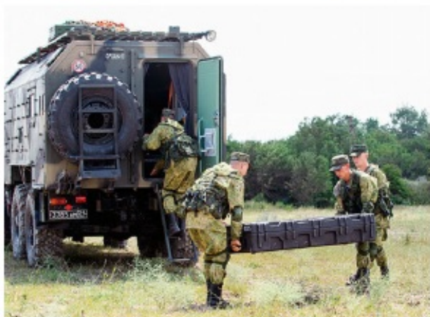
Подвижный наземный пункт управления БАК ВН «Орлан-10» на шасси многоцелевого автомобиля повышенной проходимости КамАЗ-5350 (ДИМК МО РФ).
