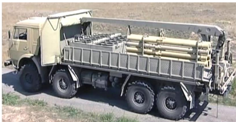
Рис. 5.4 – ТЗМ з контейнерами ЗКР і касетами 30–мм пострілів ЗРГК “Панцирь–С1”
